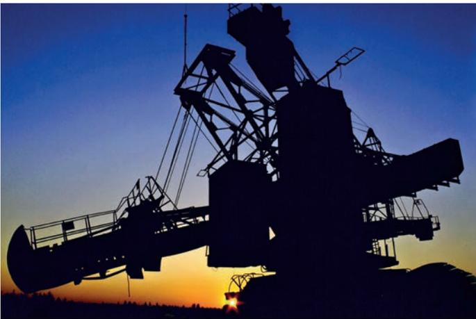
Ein kleiner Gigant im Sonnenuntergang: Der Schaufelradbagger 2 war der zweitälteste und mit der kleinste der insgesamt sechs Schaufelradbagger, die um Wackersdorf zum Einsatz gekommen sind. Die BBI setzte ihn bis 1957 im Nordfeld, bis 1970 im Tagebau Felgerwiesen und bis 1976 im Tagebau Auweiher und Lindsbügel ein.
