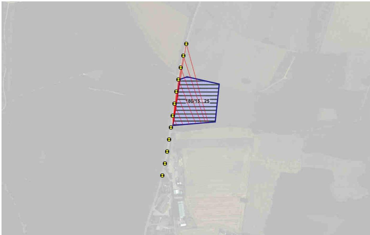
Unter diesen Blickrichtungen können die Modulkonstruktionen nur von hinten gesehen werden, so daß hier keine von den Moduloberflächen ausgehenden Blendwirkungen auftreten können.
